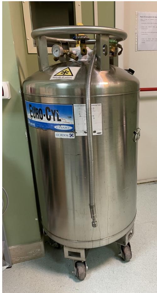
**Fig. 2c Criocontenitore pressurizzati specifici per il trasporto e la conservazione di azoto liquido**
